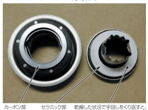
乾燥した状況で手回しをくり返すと、 セラミック部にカーボンが付着し 異音が発生する可能性があります。
