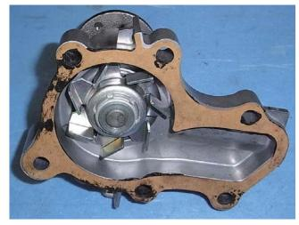
不具合事例その2…Oリング仕様に液状ガスケット使用
