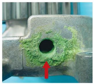
漏れた跡が大きく、漏れた跡が常に漏れて いたり、ポタポタ漏れている。
